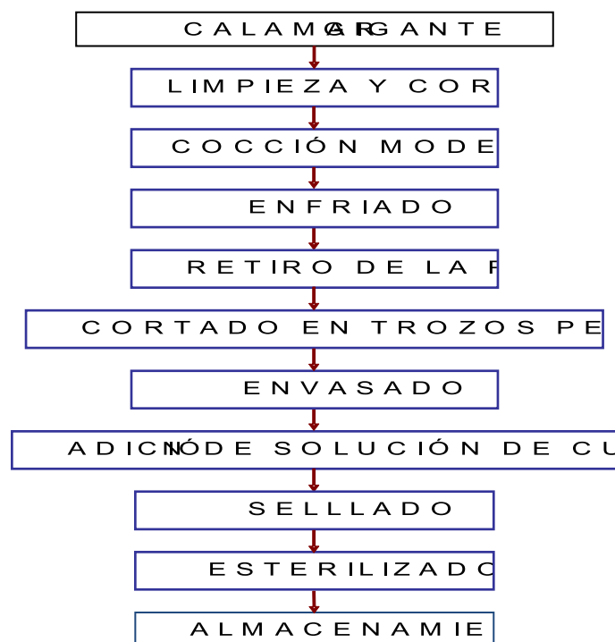
Figura 1. Diagrama de bloques para la conserva de calamar gigante empleando como solución pulpa de aceitunas.
